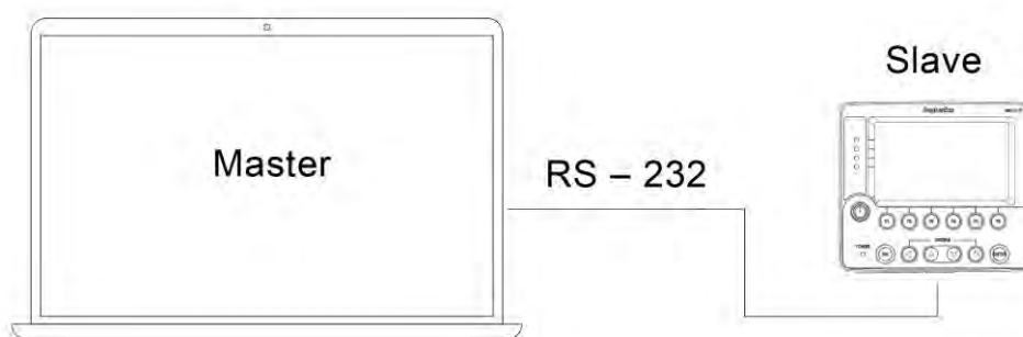
Рис. 45 – Подключение контроллера по RS-232-
