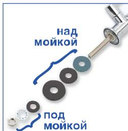
**6.** Наденьте на резьбовой хвостик крана декоративную подставку, резиновую прокладку и резиновую шайбу
