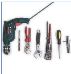
**1.** Для установки вам потребуются: дрель (сверл. с 12 мм по металлу, разводные ключи отсечка, торцевой трубчатый ключ и 1/4"
