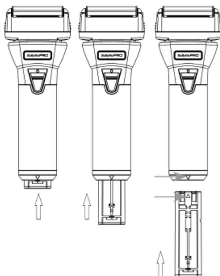
**AVERTISSEMENT** – Veiller à ce que la batterie et le compartiment à batterie soient bien alignés avant de pousser la batterie. Ne pas forcer si vous sentez une résistance quelconque.
