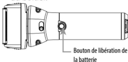
2. Tirer sur la batterie pour la retirer complètement du boîtier.
