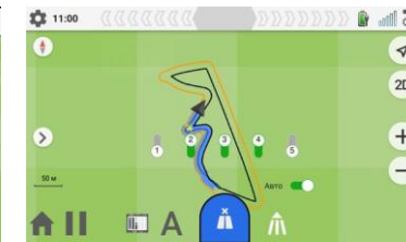
Отображение на навигационном экране разворотной полосы и контура обрабатываемого поля (при его наличии в системе). Звуковое предупреждение о приближении к разворотной полосе.
