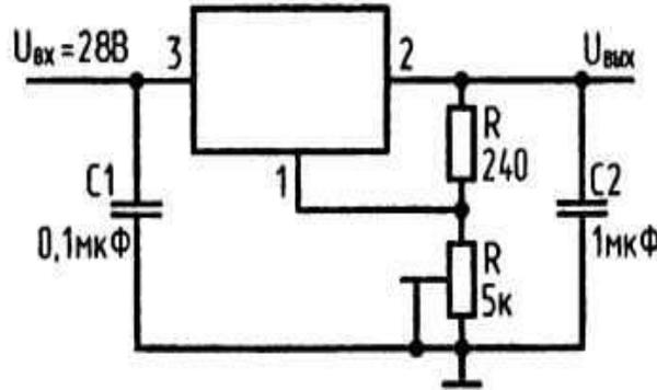
Схема включения КР1157ЕН1 в регулируемом стабилизаторе напряжения
