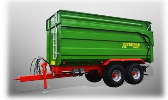
Прицеп прочный и долговечный, имеет стабильную конструкцию, о низком положении центра тяжести. Конструкция универсальна, отличается кузовом с гидравлически открывающимся задним бортом с резиновой прокладкой. Прицеп имеет прочные, стабильные шасси с амортизированным дышлом (Зт) с надежной системой колес тандем на четырех параболических рессорах.
