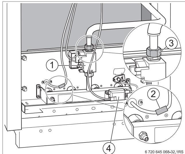
Рис. 46 Демонтаж горелки
