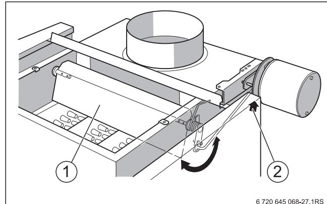
Рис. 38 Заслонка дымовых газов в положении "Закрыто"
