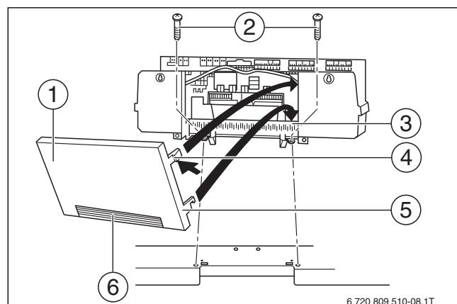
Рис. 22 Крепление Logamatic 4000
