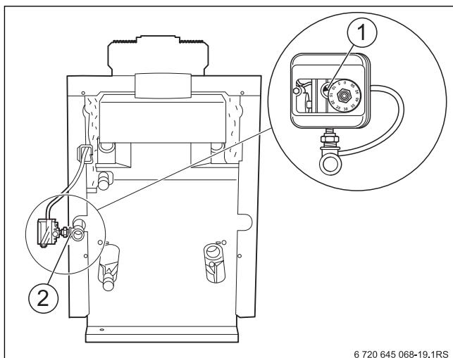
Рис. 8 Подключение газа
