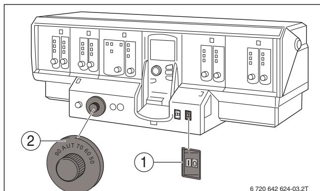
Рис. 31 Включите отопительную установку на системе управления (Logamatic 4000)
