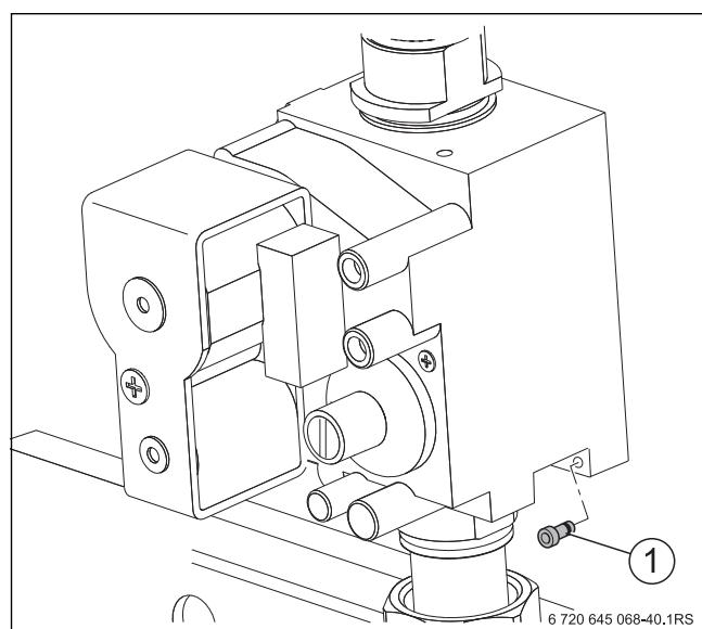
Рис. 54 Установка/удаление переходника для сжиженного газа
