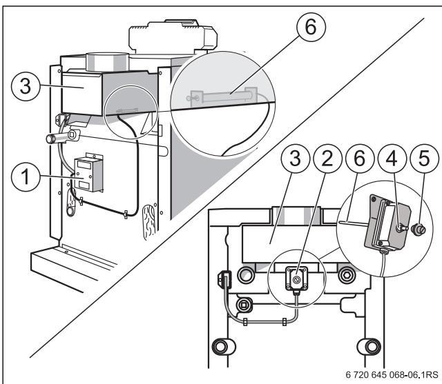
Рис. 37 Устройства контроля дымовых газов
