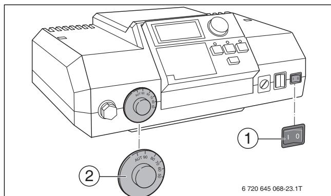
Рис. 30 Включите отопительную установку на системе управления (Logamatic 2000)
