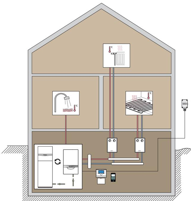
Еще одним компактным решением является котел со встроенным бойлером Vaillant ecoCOMPACT, в котором отопительный котёл и накопительный водонагреватель удачно объединены в едином корпусе. Небольшая высота и удобная для сервисного обслуживания компоновка внутренних элементов расширяют возможности размещения – вы можете установить котёл на чердаке, в подсобном помещении или на цокольном этаже вашего дома.
