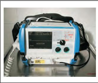
Рис. 15.18 Дефибриллятор для проведения электротерапии.
