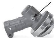
3. Заправляем шприц смазкой, сняв шток полностью - выдавливаем смазку из трубы в цилиндр шприца. Вставляем шток и вносим смазку в отверстие редуктора. Повторяем операцию при необходимости.
