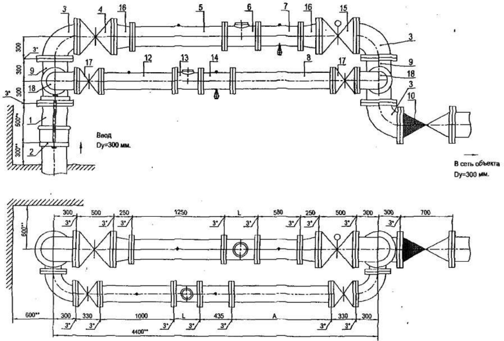
Установка счетчика  $dy=200$  мм на хозяйствственно-питьевой линии и счетчика  $dy=250$  мм на пожарно-резервной линии в водомерном узле на вводе диаметром 300 мм.
