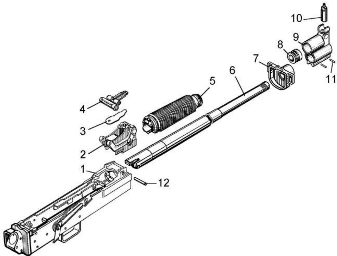
1-коробка ствольная ВПО-205 Сб1-1; 2- колодка прицельная ВПО-205 Сб1-8; 3- пружина планки прицельной СОК-94 0-23; 4-планка прицельная ВПО-205 Сб2; 5-накладка ствольная ВПО-205 Сб1-12 или накладка ствольная ВПО-205 Сб1-12-01; 6-ствол ВПО-205 1-10; 7-кольцо цевья ВПО-205 1-27; 8-поршень ВПО-205 1-20; 9-камера газовая с основанием мушки ВПО-205 Сб1-9; 10-мушка СОК-94 1-32; 11-штифт колодки мушки ВПО-205 1-39; 12-штифт ствола ВПО-205 1-34
