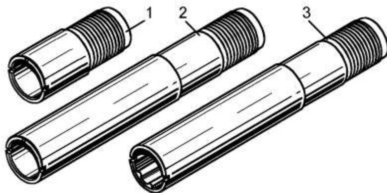
1-штулка сменная РС-12.00.12-01 или штулка сменная РС-12.00.12-02; 2-штулка сменная РС-12М.00.12 или штулка сменная РС-12М.00.12-01 или штулка сменная РС-12М.00.12-02; 3-штулка «Парадокс» РС-12М.00.13
