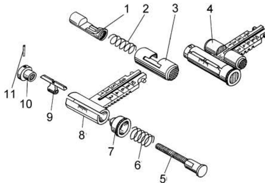
1-защелка хомутика СОК-94 2-3; 2-пружина защелки хомутика СОК-94 2-4; 3-хомутик планки прицельной СОК-94 2-2; 4-планка прицельная ВПО-205 С62; 5- винт СОК-93 2-7; 6-пружина фиксатора прицела СОК-94 2-8; 7-фиксатор СОК-94 2-6; 8-планка прицельная ВПО-205 2-1; 9- целик ВПО-102 2-5; 10- гайка СОК-94 2-9; 11- штифт СОК-94 2-10
