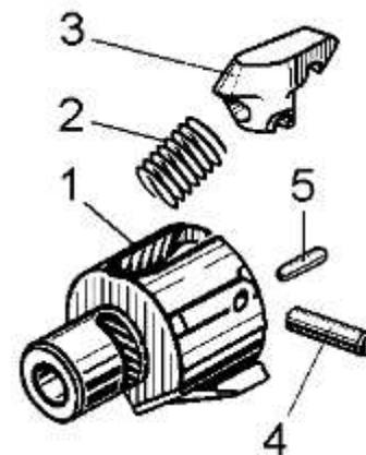
1- головка затвора ВПО-205 3-15-01; 2- пружина выбрасывателя СОК-94 3-7; 3- выбрасыватель ВПО-205 3-11; 4- ось выбрасывателя ВПО-205 3-10; 5- штифт РП-12М.03.02
