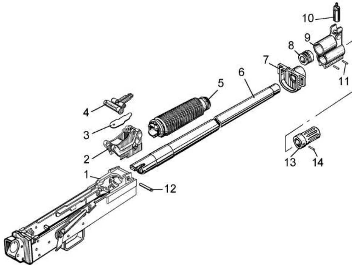
1- коробка ствольная ВПО-205 Сб1-1; 2- колодка прицельная ВПО-205 Сб1-8; 3- пружина планки прицельной СОК-94 0-23; 4- планка прицельная ВПО-205 Сб2; 5- накладка ствольная ВПО-205 Сб1-12; 6- ствол ВПО-205 1-10-01; 7- кольцо цевья ВПО-205 1-27; 8- поршень ВПО-205 1-20; 9- камера газовая с основанием мушки ВПО-205 Сб1-9; 10- мушка СОК-94 1-32; 11- штифт колодки мушки ВПО-205 1-39; 12- штифт ствола ВПО-205 1-34; 13- насадок дульный ВПО-205 1-33; 14- штифт ВПО-205 4-5-01
