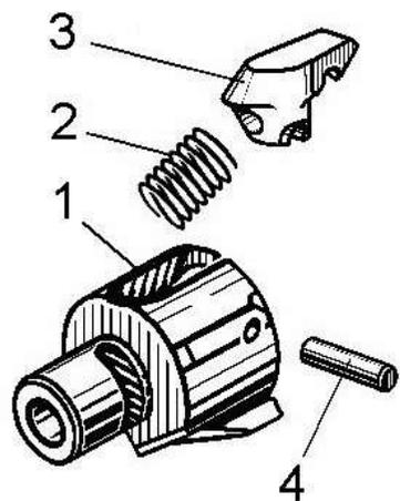
1- головка затвора ВПО-205 3-15; 2- пружина выбрасывателя СОК-94 3-7; 3- выбрасыватель ВПО-205 3-11; 4- ось выбрасывателя ВПО-205 3-10
