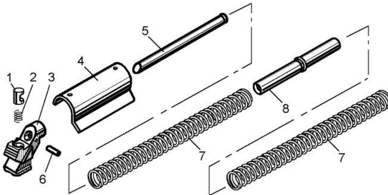
1- гнеток ВПО-205 4-8; 2- пружина зацепа РП-16.02.18; 3- направляющая пружины возвратной ВПО-205 4 -1; 4- шторка в сборе ВПО-205 Сб4-1; 5- стержень направляющий ВПО-205 4-2; 6- штифт ВПО-205 4-5; 7- пружина возвратная ВПО-205 4-3; 8- втулка направляющая ВПО-205 4-4
