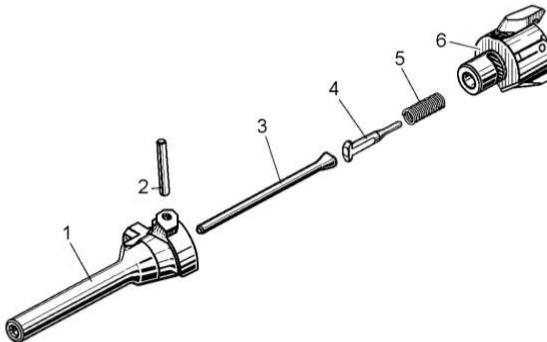
1- затвор ВПО-205 3-4-01; 2- штифт головки затвора ВПО-205 3-9; 3- ударник ВПО-205 3-5; 4- боек ВПО-205 3-16; 5- пружина бойка ВПО-205 3-14; 6- головка затвора ВПО-205 С63-3-02 или головка затвора ВПО-205 С63-3-03
