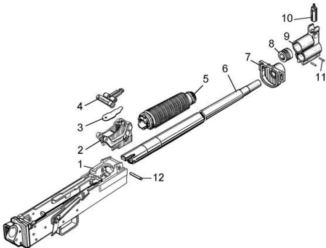
1- коробка ствольная ВПО-205 Сб1-1; 2- колодка прицельная ВПО-205 Сб1-8; 3- пружина планки прицельной СОК-94 0-23; 4- планка прицельная ВПО-205 Сб2; 5- накладка ствольная ВПО-205 Сб1-12; 6- ствол ВПО-205 1-10-02; 7- кольцо цевья ВПО-205 1-27; 8- поршень ВПО-205 1-20; 9- камера газовая с основанием мушки ВПО-205 Сб1-9; 10- мушка СОК-94 1-32; 11- штифт колодки мушки ВПО-205 1-39; 12- штифт ствола ВПО-205 1-34
