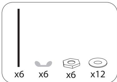
Сначала вкрутите шпильку на глубину 15 мм, после чего зафиксируйте ее шайбой с гайкой. Затем установите и зафиксируйте ногу.
