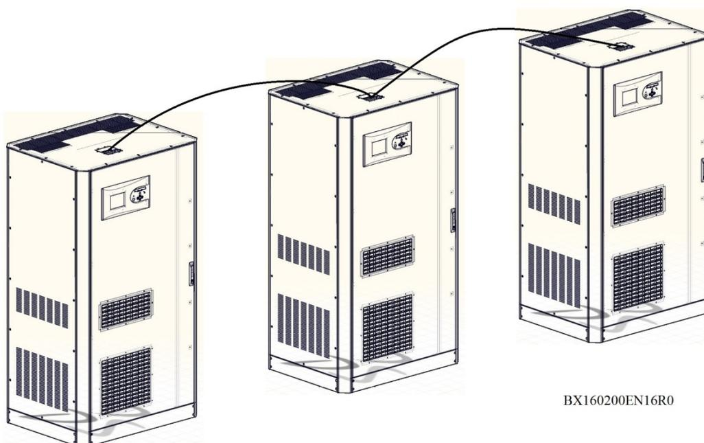
РАЗЪЕМ ДЛЯ ПАРАЛЛЕЛЬНОГО СОЕДИНЕНИЯ
