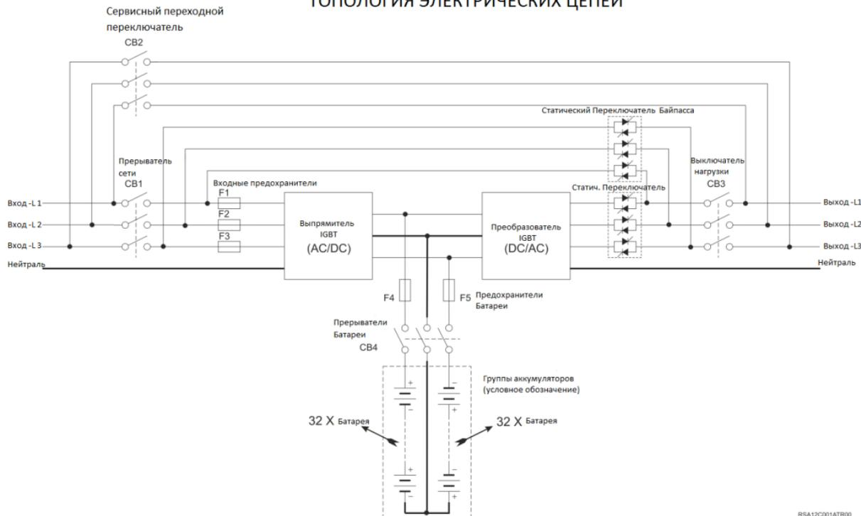
Энергия поступает в ИБП посредством переключателя СВ1. Выпрямитель преобразует AC переменный ток сети в DC напряжение постоянного тока и заряжает батареи в управляемом режиме. DC напряжение, с использованием преобразователя (инвертора), синхронно с сетью преобразуется в AC напряжение. Это напряжение высокого качества. Производимая AC энергия, проходя через статический полупроводниковый переключатель и выходные прерыватели, применяется к нагрузкам.
