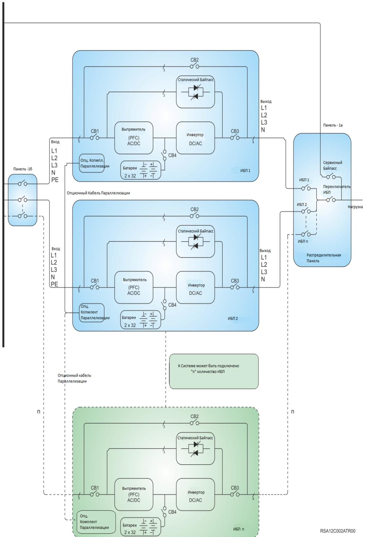
В ходе параллельной работы, входы и выходы приборов в количестве более одного соединяются друг с другом. Но, группа аккумуляторов каждого прибора непременно должна быть отдельной. Аккумуляторы не используются совместно. При размещении приборов в параллельной системе и выполнении электрических соединений необходимо принять во внимание следующие нюансы:
