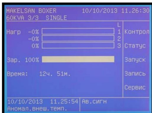
При включении передней панели прежде всего отображается начальный экран. На нем указаны наименование модели, дата-время, состояние нагрузки в %, состояние зарядки в %, время работы от аккумулятора, режим работы прибора, активные тревожные сообщения и основные заголовки меню. Тревожные сообщения отображаются в нижней левой строке. Если в течении пяти минут не будет нажата какая-либо кнопка, система вернется к начальному экрану
