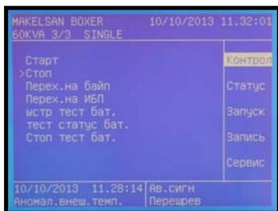
3. Получите подтверждение перехода прибора в режим байпас с индикаторов на передней панели и ЖК экрана.
