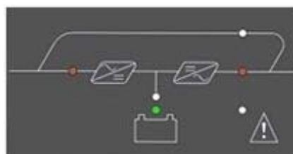
Примечание: Если вольтаж преобразователя не соответствует требуемым критериям, если имеется перегрузка и перегрев, преобразователь не примет на себя нагрузку.
