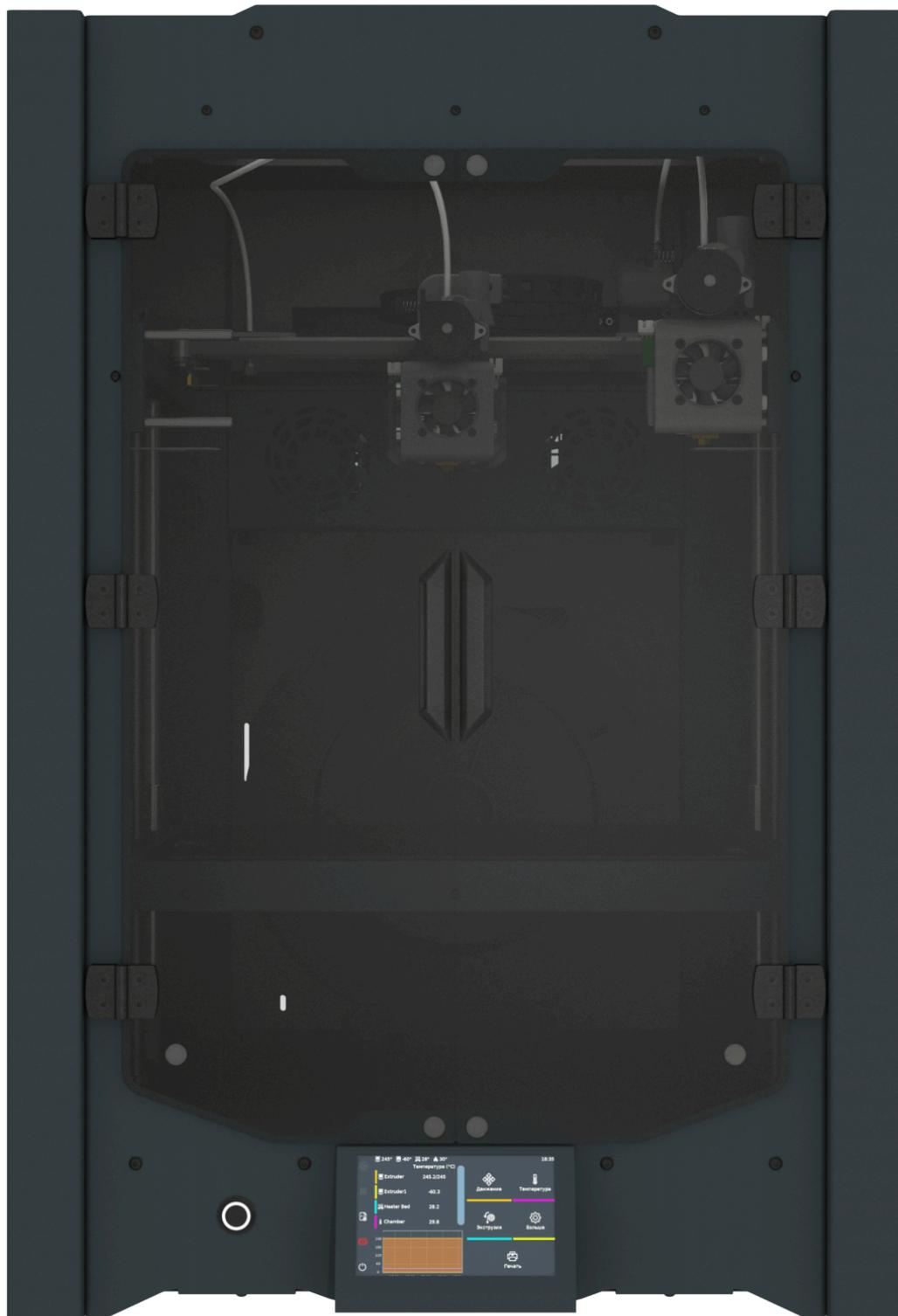
Z-Bolt S300 HT Dual – это 3D принтер с двумя независимыми печатающими головами и областью построения 300\*300\*350мм, позволяющий печатать с высокой скоростью самыми сложными материалами.
