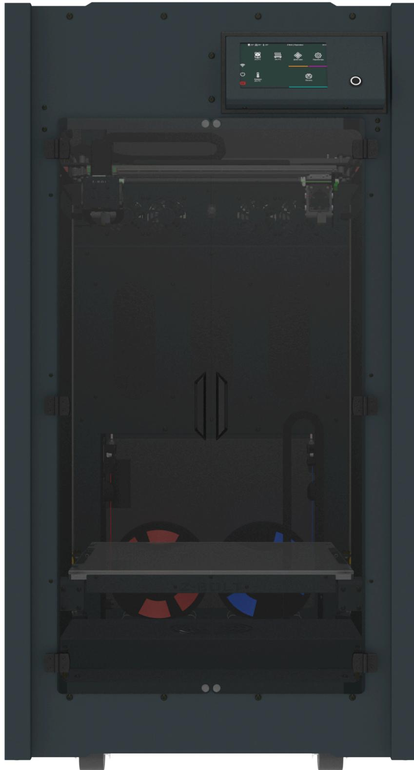
Z-Bolt S400 HT Dual – это 3D принтер с областью построения 400\*400\*700мм, закрытой камерой, нагреваемым рабочим объемом и двумя печатающими головами, позволяющий печатать с высокой скоростью самыми сложными материалами и их комбинациями.
