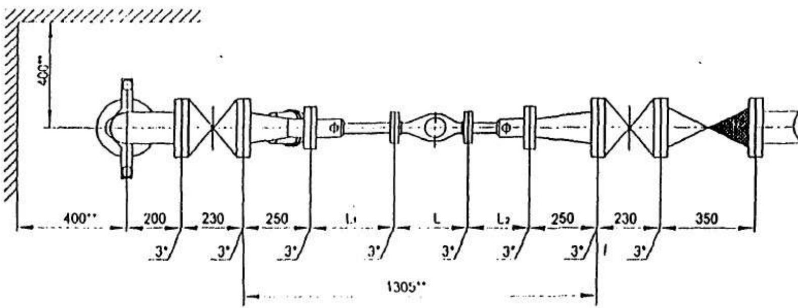
Установка счетчиков Dу=20...50 мм с фильтром-переходом (Ф1)
