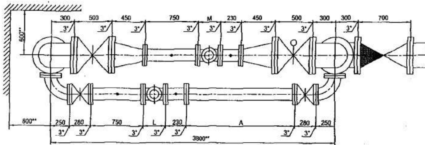
Установка счетчика dy=150 мм на хозяйственно-питьевой линии и счетчика фу=150 мм на пожарно-резервной линии в водомерном узле на вводе диаметром 300 мм.
