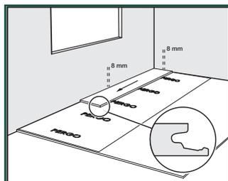
Возьмите первую планку, которая будет уложена в углу. Отпилите профиль с замком с длинной и короткой сторон планки. Для других планок первого ряда (которые не будут уложены в углу) удалите профиль с замком с длинной стороны, которая будет уложена ближе к стене. Профиль с замком нужно удалить с каждой стороны планки, которая будет лежать вплотную к стене, чтобы оставить требуемый температурный шов.
