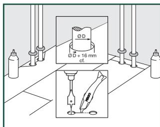
В рядах, где рядом проходят две трубы, выполните следующие действия. 1. Измерьте расстояние до того места, где труба проходит через планку. Не забудьте оставить место для температурного шва. Отмерьте расстояние, превышающее диаметр трубы для компенсации. 2. Просверлите панель в месте, где должна пройти труба. 3. Расширьте отверстие до края панели. 4. Уложите панель вокруг трубы.
