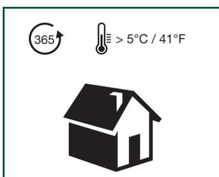
Виниловое покрытие Pergo Rigid Click предназначено для монтажа в отапливаемых помещениях (> 5°C), желательно при нормальной комнатной температуре (18–30°C).
