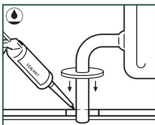
Для придания полу вокруг труб законченного вида используйте накладки для труб. Уложите полиэтиленовый уплотнитель и нанесите на него герметик Pergo® Aqua sealant, учитывая температурный шов шириной 8 мм. Уложите полиэтиленовый уплотнитель в температурные швы. Еще раз нанесите герметик Aqua sealant на уплотнитель. Затем установите накладки для труб плавающим способом.
