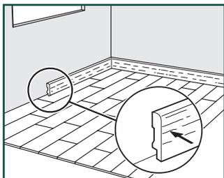
Прикрепите плинтус к стене. Никогда не крепите плинтус к полу. Благодаря этому пол сможет расширяться и сжиматься под плинтусом. Не заполняйте температурный шов силиконом или другим герметиком.
