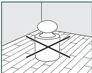
Запрещается препятствовать свободному движению пола. При наличии на полу тяжелых предметов (например, кухонных гарнитуров, островков, встроенных шкафов, тяжелых плит, электрических аккумуляторов) они действуют как стены.
