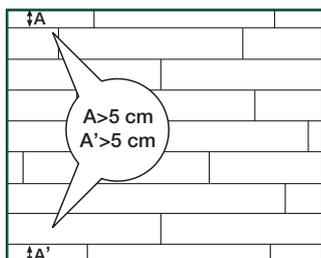
Перед началом работ тщательно измерьте длину и ширину помещения, чтобы точно определить способ укладки, который обеспечит гармоничный внешний вид пола. Это особенно важно при использовании плиток с типовым узором. Кроме того, убедитесь, что при выбранном плане укладки последний ряд планок не будет слишком узким. Если ширина последнего ряда оказывается менее 5 см, то для удобства рекомендуется уменьшить ширину планок первого ряда.
