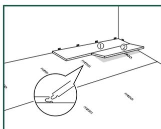
Панки Uniclic® можно устанавливать двумя разными способами.
