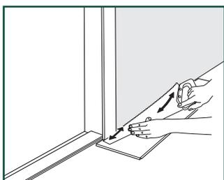
Если при укладке нового поля имеется порог или дверной проем, рекомендуется подрезать дверную коробку или наличники. Чтобы правильно выполнить подрез, переверните планку, уложите ее на подложку и приложите на полу к дверной коробке. Так вы наметите подрез на нужной высоте. Затем положите универсальный инструмент или ножовку на планку и просто подрежьте коробку. Удалите выпиленный брусок и соберите мусор с помощью пылесоса.
