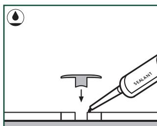
Прикрепите профиль Incizo к основанию пола (например, с помощью клея Pergo). Нанесите герметик Aqua sealant на полиэтиленовый уплотнитель, уложенный в температурном шве.
