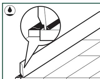
Прикрепите плинтус к стене клеем Pergo. При установке плинтуса или скоции в цвет используйте соответствующую гибкий профиль из ПВХ Hydrostrip, чтобы предотвратить проникновение воды и придать напольному покрытию аккуратный внешний вид.
