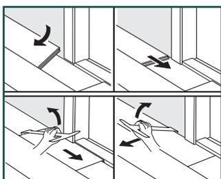
При отпиливании панелей оставьте под дверь температурный шов шириной 8 мм.
