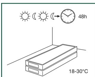
Соблюдайте осторожность при транспортировке и хранении жестких виниловых полов Pergo во избежание их деформации. Для хранения и транспортировки уложите упаковки на плоскую поверхность аккуратными рядами. Запрещается хранить упаковки в вертикальном положении, а также во влажных и пыльных помещениях. Запрещается хранить упаковки в очень холодных (< 5°C) или очень жарких (> 35°C) помещениях, а также в помещениях с высокой влажностью.
