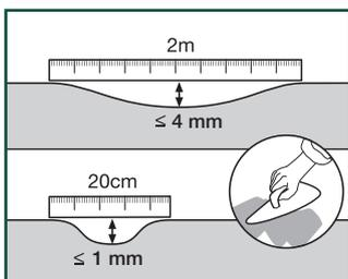
При использовании замкового напольного покрытия Pergo Rigid Click необходимо устранить все неровности более 1 мм на отрезке длиной 20 см. Это относится также к неровностям более 4 мм на отрезке длиной 2 м
