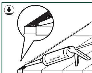
Для герметизации температурных швов по периметру используется полиэтиленовый уплотнитель и герметик Pergo® Aqua sealant. Плотно уложите полиэтиленовый уплотнитель в температурные швы с помощью самоклеящейся основы и нанесите герметик Pergo® Aqua sealant под небольшим углом к полу Pergo®. Толщина слоя герметика Aqua sealant на стене и на полу должна составлять 1–2 мм. Полиэтиленовый уплотнитель должен быть покрыт герметиком полностью.
