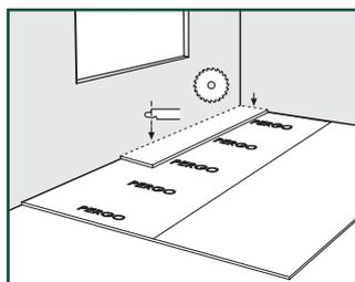
При использовании замкового напольного покрытия Pergo Rigid Click можно выбрать, откуда начать монтаж пола. Подумайте о том, какой способ укладки пола будет самым простым. В этом руководстве приведен пример монтажа пола Pergo Rigid Click для правшей, справа налево (если смотреть спереди). Система замков Uniclic позволяет работать в любом направлении.
