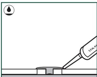
Приложите профиль Incizo к полу с нанесенным герметиком Aqua sealant. Добавьте герметик Aqua sealant в точках соприкосновения профиля Incizo с полом, чтобы обеспечить полную водонепроницаемость.
