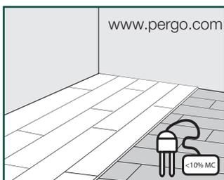
Если монтаж выполняется на деревянный черновой пол, сначала снимите имеющееся напольное покрытие. На полу не должно быть никаких признаков плесени и/или заражения насекомыми. Если в деревянном черновом основании содержится влага или под деревянным черновым полом нет подходящего гидроизолирующего слоя, необходимо снять черновой пол.
