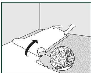
От типа чернового пола, его качества и подготовки в значительной степени зависит окончательный результат монтажа. Если черновой пол не подходит для монтажа планок Pergo Rigid Click, необходимо принять соответствующие меры. Помните, что неровности чернового пола могут оставить следы на полу Pergo Rigid Click и вызвать образование щелей
