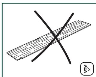
Проверяйте все планки перед монтажом и во время него в оптимальных условиях освещения под углом, чтобы отражался свет. Не используйте планки с дефектами. 4
