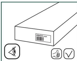
В продаже имеются напольные покрытия Pergo Rigid Click с разным рисунком поверхности, различного формата и качества. Перед началом монтажа убедитесь в соответствии полученного напольного покрытия заказанному. Рекомендуется сохранить этикетки с торцов коробок и чек.
