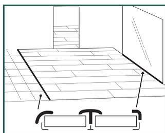
В большинстве случаев не нужно устанавливать расширительный профиль между помещениями. Однако в следующих случаях его использование обязательно:
