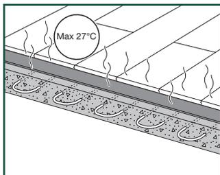
Системы подогрева пола (водяные или электрические), встроенные в стяжку, можно использовать с напольными покрытиями Pergo Rigid Click, если на время акклиматизации, монтажа и в течение 48 часов после монтажа может быть обеспечена постоянная температура пола и воздуха в помещении не ниже 18°C. Для обеспечения безопасности и гигиены труда и во избежание порчи пола Pergo Rigid Click допускается температура поверхности пола не более 27°C.
