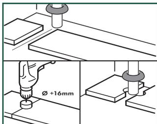
В тех рядах, где проходит труба, убедитесь, что она попадает точно в стык между двумя планками с короткой стороны. Возьмите сверло, диаметр которого больше диаметра трубы на для компенсации. Соедините планки по короткой стороне и добавьте третью планку по длинной стороне для придания прочности. Просверлите отверстие по центру стыка двух планок. Теперь можно установить планки.
