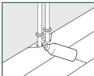
Для придания полу вокруг труб законченного вида используйте накладки для труб (для плавающего способа укладки).
