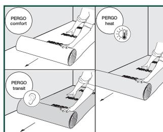
Рекомендуется уложить первую полосу подложки параллельно длинной стороне пола Pergo Rigid Click и постепенно добавлять полосы подложки по мере монтажа пола. При укладке следующего ряда подложки рекомендуется соединить ряды с помощью тонкой клейкой ленты, чтобы они не наложились друг на друга.
