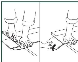
Чтобы обрезать планку Pergo Rigid Click по прямой, уложите ее лицевой стороной вверх и обрежьте с помощью специального вогнутого ножа для виниловых полов. Чтобы обрезать виниловую планку, наметьте на ней прямую линию и с помощью ножа сделайте глубокий надрез в поверхности. Не требуется разрезать планку насквозь. Затем разломите планку двумя руками. В других случаях потребуется отпилить планку.
