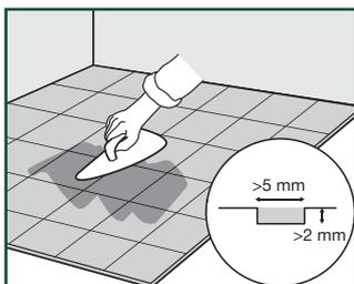
Цементные стыки между плитками и другие швы глубиной более 2 мм и шириной более 5 мм необходимо выровнять.
