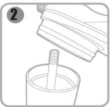
Демонтируйте гайку задней крышки. Легкими поступательными движениями резинового молотка демонтируйте заднюю крышку помпы и слейте отработанное масло в заранее подготовленную для этого емкость. Замеряйте объем слитого отработанного масла.
