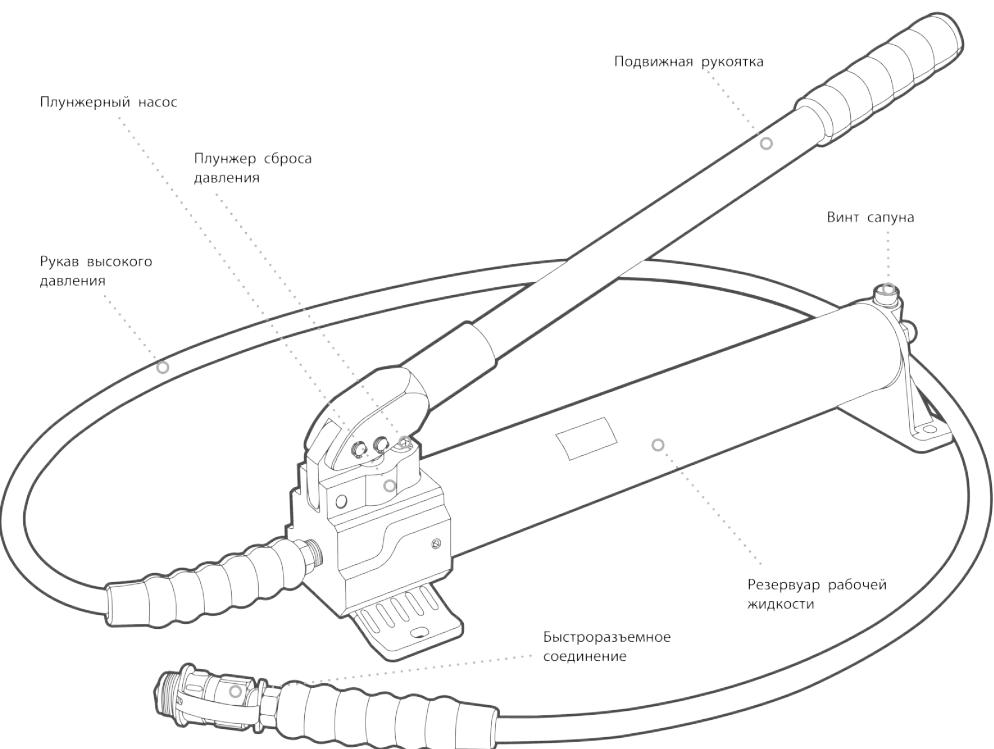
В конструкции помпы предусмотрен механизм автоматического сброса давления (АСД), при достижении максимальной рабочей нагрузки. Также при достижении максимальной рабочей нагрузки у помпы включается функция удержания штока исполнительного инструмента.
