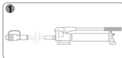
Установите помпу по возможности на ровной, плоской поверхности. Такое положение обеспечит устойчивость насоса во время работы.
