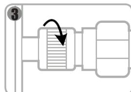
Плотно затяните гильзу БРС, приложив достаточное усилие (от руки) для обеспечения хорошего соединения (без применения слесарного инструмента).
