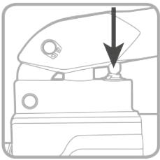
Нагнетайте давление рукояткой до завершения операции (при опрессовке - смыкание матриц, при резке - полное перерезание кабеля или до срабатывания АСД).
