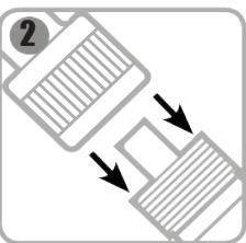
Открутите гильзу быстроразъемного соединения и отсоедините рукав помпы от исполняющего инструмента.
