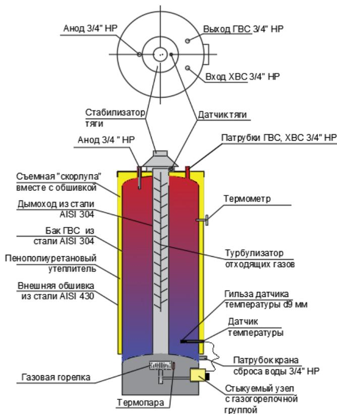
Для усиления процесса теплообмена в трубе установлен турбулизатор отходящих газов, который создает сопротивление движению отходящих дымов и создает турбулентное течение дымов.
