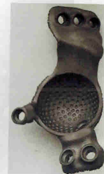
Рис. 5.15. Печать трехфланцевого индивидуального вертлужного компонента на 3D-принтере из титанового порошка
