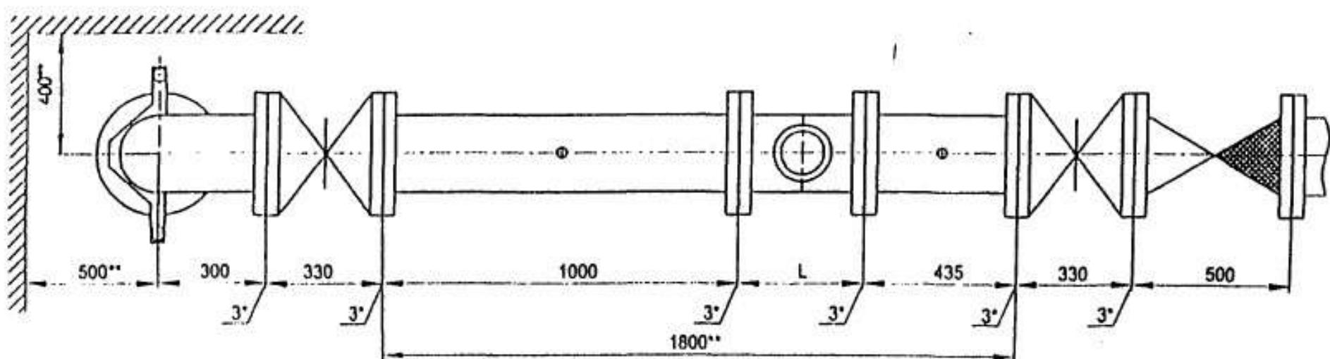
Установка счетчика  $D_y=200$  мм в водомерном узле
