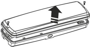
**2** Отожмите защелки на панели со светодиодной матрицей, откиньте панель.
