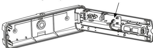
**6** Соберите светильник в обратной последовательности. Включите питание светильника и проверьте, горит ли зеленый светодиодный индикатор, чтобы подтвердить зарядку батареи. При первом использовании, после непрерывной зарядки в течение 24 часов, следует имитировать сбой в сети, чтобы убедиться, что светильник работает в течение указанного времени (только в безопасное и подходящее время).
