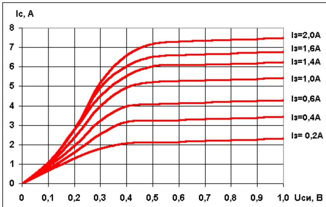
Типовая зависимость тока затвора от напряжения затвор-исток транзисторов КП810А,Б,В.
