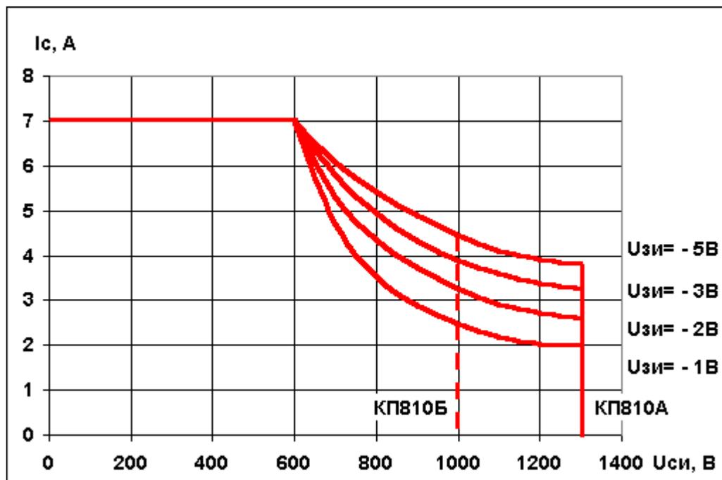
Область безопасной работы КР810В при переключении в режиме обратного динамического смещения  $T_{корп} < 85^\circ\text{C}$ .
