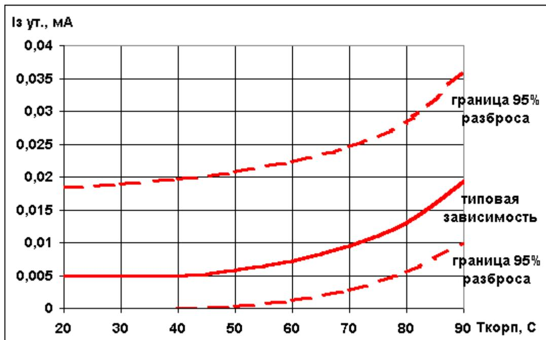
Типовая зависимость тока утечки сток-исток от температуры корпуса транзисторов КР810А,Б,В.
