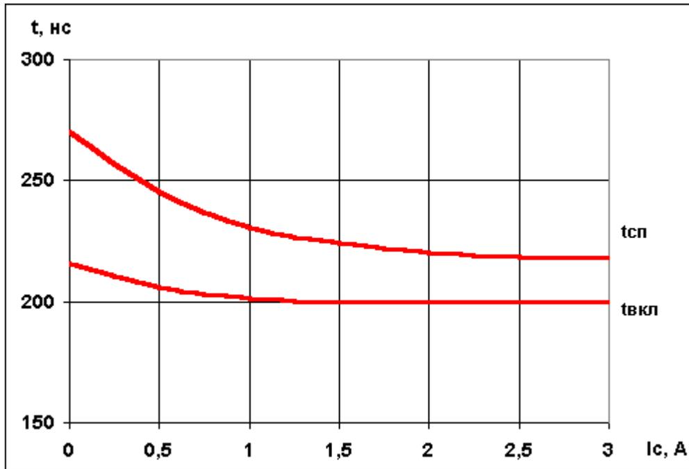
Типовая зависимость времени рассасывания от тока стока транзисторов КР810А,Б,В
