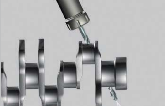
Сверление отверстия под штифт (сверла MLD)
