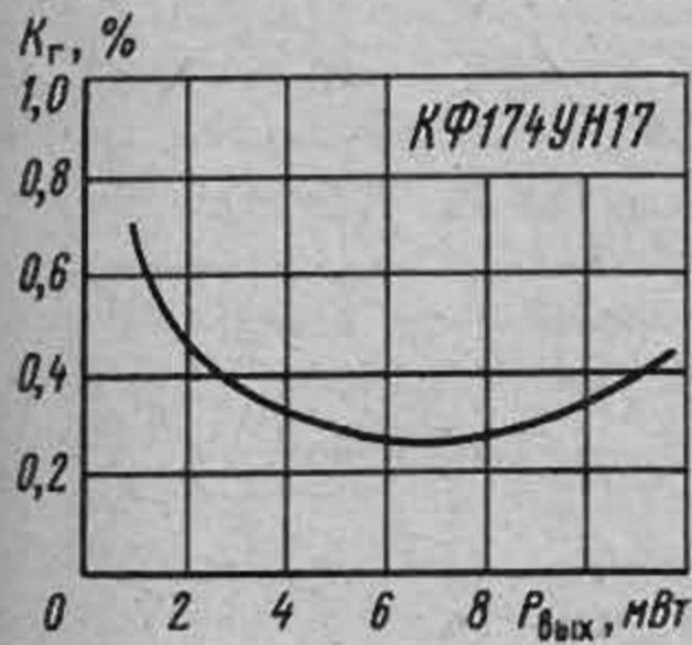
Зависимость коэффициента гармоник от выходной мощности при U_n = 3 В, f = 1 кГц, R_n = 40 Ом
