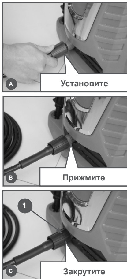
Рис. 4 Подключение шланга высокого давления
