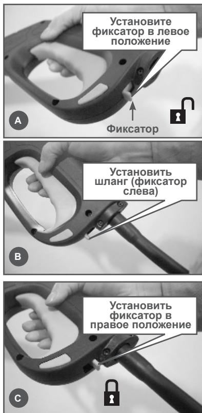
Рис. 3 Подключение шланга высокого давления к пистолету
