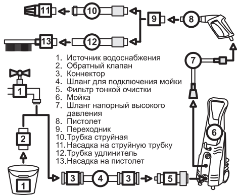
Рис. 13 Схема подключения аппарата с дополнительным оборудованием
