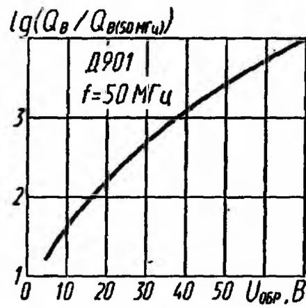
Зависимость относительной добротности от напряжения
