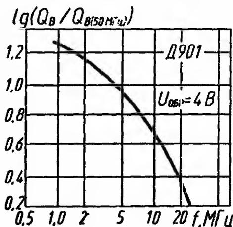
Зависимость относительной добротности от частоты
