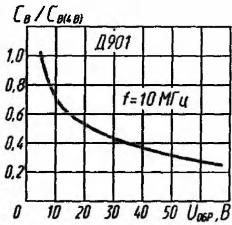
Зависимость относительной емкости от напряжения
