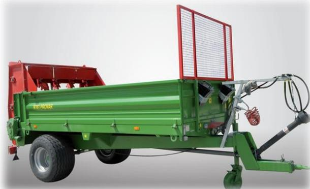
Благодаря использованию прикрученных лопастей типа „рога лося” они легко обмениваются. Кузов разбрасывателя разработан таким образом, что позволяет быстро открывать его боковые стены. Конструкция подающего механизма основана на четырех цепях из высокопрочной стали, соединенных сгребающими планками.
