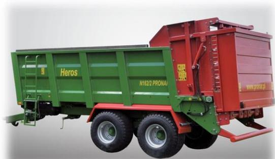
Стандартно оснащен адаптером с четырьмя вертикальными движущимися элементами, закрытыми откидной задвижкой. Подвеска типа тандем с шинами 550/50-22.5 обеспечивает минимальное углубление в почве.
