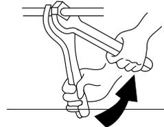
Затяните гайки ключом.
