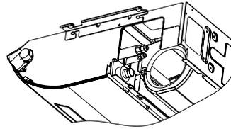
Разрежьте удаленную верхнюю крышку и установите на заднюю панель вместо задней крышки.
