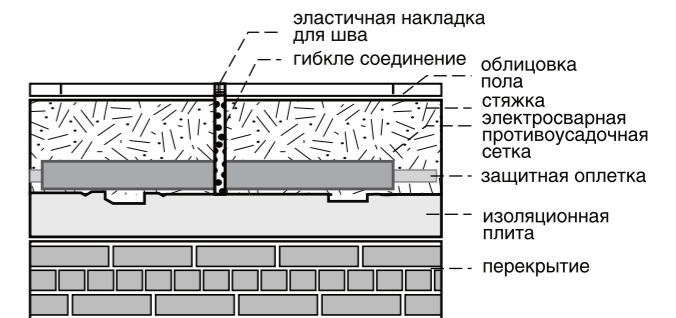
Рисунок 43. Схема укладки деформационного шва.
