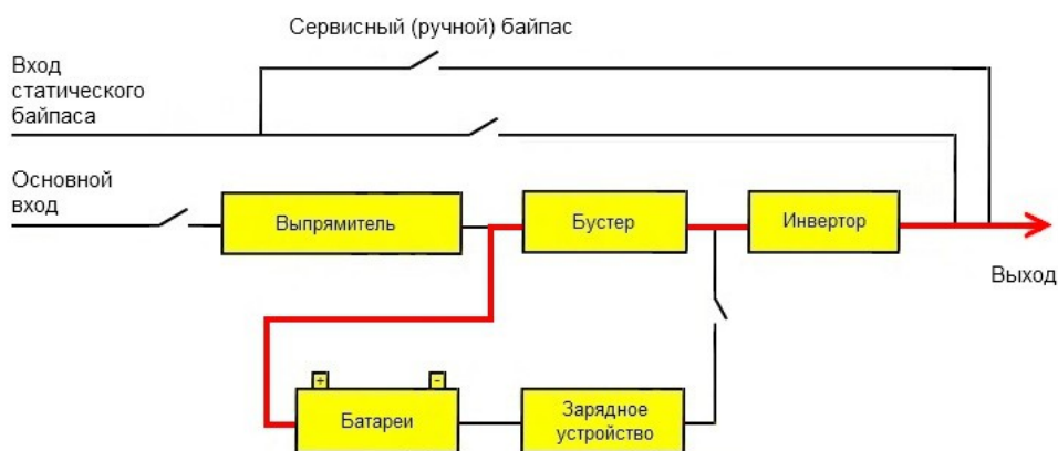
Схема работы в режиме от батарей.
