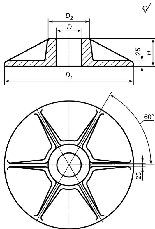
Рисунок 4 — Анкерная плита (поз. 12 на рисунке 1)
