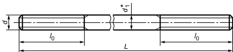
Рисунок 2 — Конструкция и размеры шпилек, лист 1
