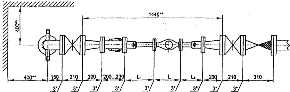
Установка счетчиков  $d_u=20...50$  мм в водомерном узле на вводе диаметром 80 мм.
