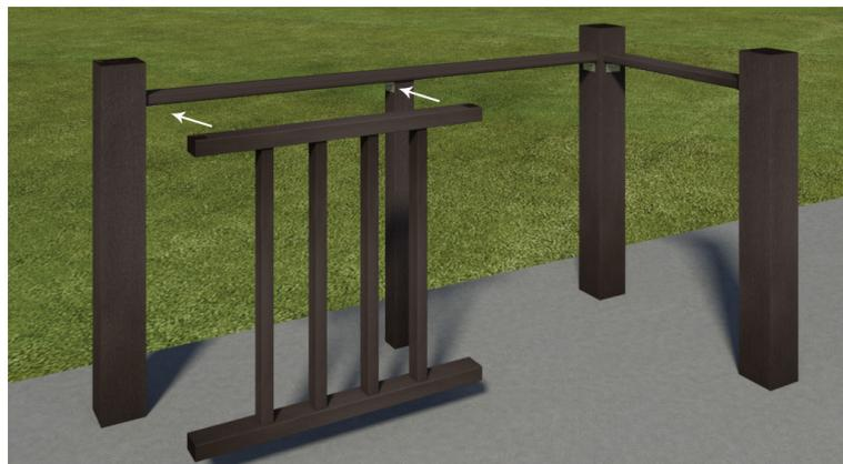
Закрепить секцию ограждения к столбам снизу при помощи саморезов и уголков в предварительно засверленные в столбах отверстия.
