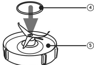
2) Вставьте ножевой блок (5) в основание чаши (3) (Рис. 1). Для фиксации ножевого блока поверните его (уже в сборе с резиновой прокладкой (4)), в направлении символа закрытого замка до полного замыкания блока в основании чаши (Рис. 2). Теперь стеклянная чаша блендера (3) полностью собрана в комплекте с ножевым блоком (5) (Рис. 3).
