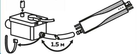
**7** Подсоедините к насосу выпускную трубку 6x9 мм, затянув соединение хомутом-стяжкой. Проверьте, чтобы на всем протяжении трубки не было заломов и других препятствий для свободного отвода конденсата.
