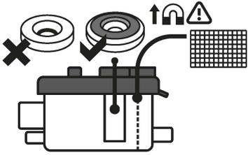
**2** Убедитесь в том, что датчик устанавливается на ровной горизонтальной поверхности.
