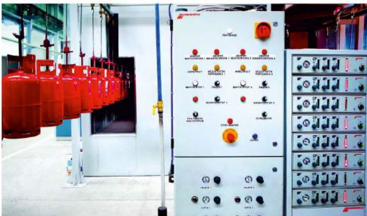
▲ Линия полимерной покраски 12 л. и 27 л. газовых евробаллонов
