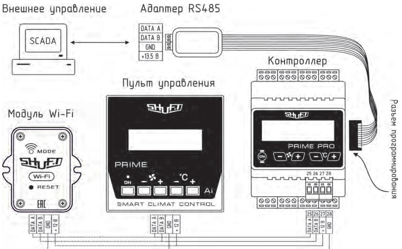
Рис. 6.4 Подключение внешних средств ДУ + SCADA
