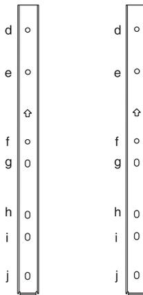
**Положение скоб** – При установке телевизора на кронштейн основания.
