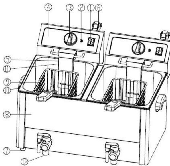
1. КНОПКА ВКЛ.      2. СВЕТОВОЙ ИНДИКАТОР      3. КОНТРОЛЛЕР ТЕМПЕРАТУРЫ      4. ЭЛЕКТРОМОНТАЖНАЯ КОРОБКА      5. ТРУБЧАТЫЙ ЭЛЕКТРОНАГРЕВАТЕЛЬ      6. КАБЕЛЬ ПИТАНИЯ      7. РЕЗИНОВАЯ НОЖКА      8. КОРПУС      9. ЖАРОЧНАЯ КОРЗИНА      10. ЧАША ДЛЯ МАСЛА      11. ЩИТ ЭЛЕКТРОНАГРЕВАТЕЛЯ      12. КРАН ДЛЯ СЛИВА МАСЛА
