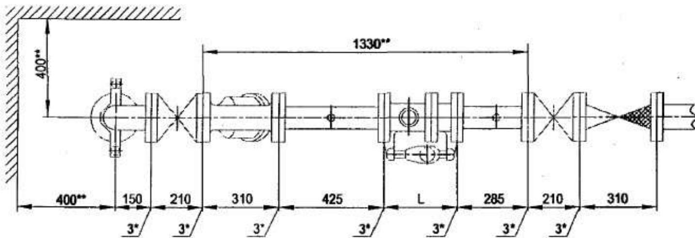
Установка комбинированного счетчика с диаметром основного канала ду=80 мм
