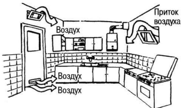
2.1.5 Запрещается устанавливать аппарат над источником тепла или открытого пламени (например, над газовой плитой, электрическими нагревательными приборами).
