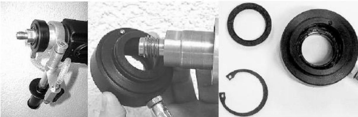
Машина имеет внешнюю подачу воды через рабочий шпиндель. Посредством шарового крана расход воды регулируется в соответствии с потребностью. Водная подача оборудована разъемом типа «Gardena» для подсоединения шланга.
