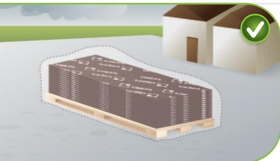
Если фанера временно хранится на открытом воздухе, укройте ее непромокаемым материалом. Защитите торцы от проникновения влаги. Поддоны, деревянные прокладки или деревянные бруски-прокладки должны быть сухими, чтобы не осталось следов на пленке.
