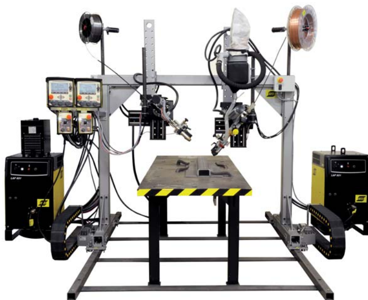
Mechtrac, оснащенный сварочными головками A2, блоками управления PEK и источниками тока LAF 631
