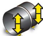
Соединение секций трубы с использованием роликовых опор с гидравлической системой стыковки. Внутренняя и наружная дуговая сварка под флюсом, выполняемая системой колонны со стрелой.
