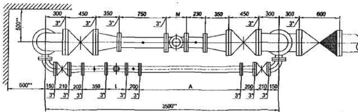
Установка счетчика  $du=65$  мм на хозяйственно-питьевой линии и счетчика  $du=150$  мм на пожарно-резервной линии в водомерном узле на вводе диаметром 250 мм.
