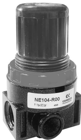
Регуляторы Серии NE поставляются с присоединительной резьбой G1/4. Регулятор имеет мембрану с отверстием для сброса выходного давления, превышающего уровень настройки.
